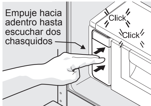
Vuelva a instalar el filtro de agua
