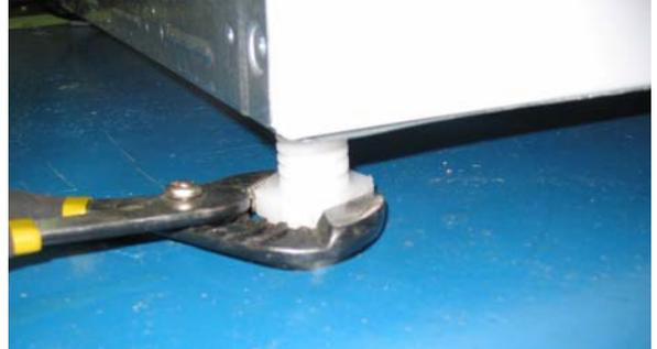
Appuyez des coins et des côtés alternatifs et sentez pour le plus léger mouvement. Ajustez la jambe appropriée ainsi la laveuse est PLEINE sur le plancher sur CHACUNE DES quatre jambes. Gardez la prolongation de mise à niveau de jambe à un minimum pour la meilleure exécution de la laveuse.
