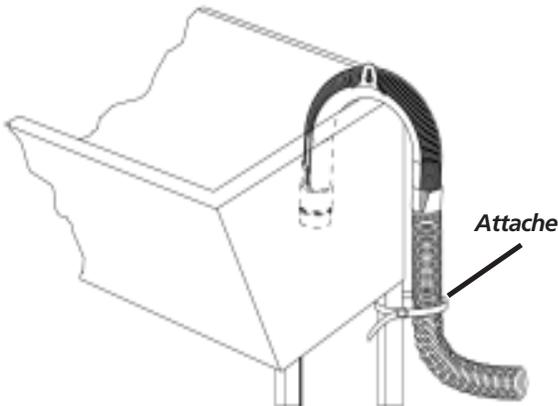
5. Placez l'extrémité de crochet de la tuyau de drain dans l'ouverture de drain. Fixez la tuyau de draun avec le serre-câble (fourni dans le paquet de clôture) à la colonne, le tuyau d'admission, le baquet de blanchisserie, etc. ainsi le tuyau ne retire pas de la force de l'eau.
