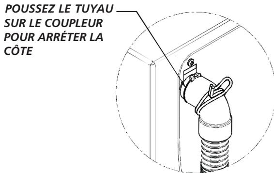
3. En utilisant des pinces, serrez les oreilles de la attache de ressort et placez la attache ainsi les oreilles de attache alignent avec et entrent en contact avec les étiquettes sur la tuyau de drain. Ceci assure l'endroit approprié de la attache pour empêcher des fuites.
