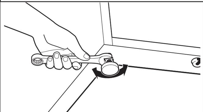
Cuando la lavadora/secadora esté nivelada, utilice una llave de boca de 9/16" para ajustar firmemente las 4 tuercas fiadoras contra el pedestal.
