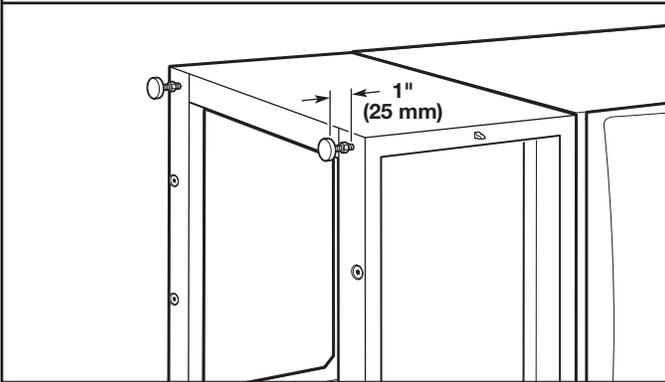
Usando un trinquete de cabeza hexagonal o una llave de boca de 1/4", baje las patas alejándolas aproximadamente 1" (25 mm) de la base del pedestal.
