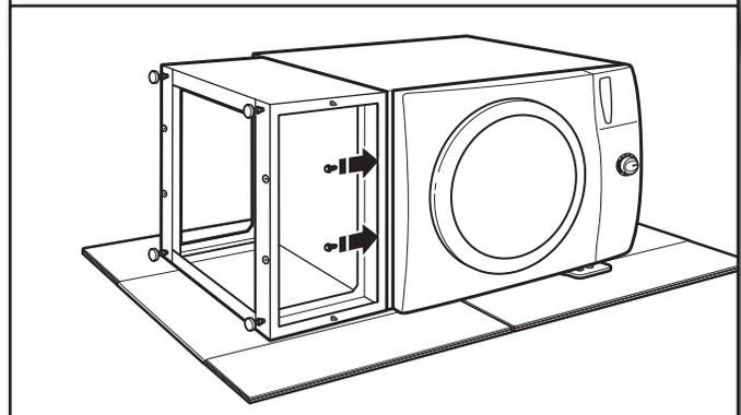
Posicione el pedestal hacia la parte frontal de la lavadora e instale los otros dos tornillos para lámina metálica de cabeza hexagonal. No los apriete completamente. Ahora vaya a "Complete la instalación del pedestal".
