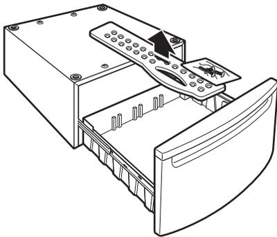
Abra el cajón del pedestal tanto como sea posible y quite su contenido. El paquete contiene 4 tornillos para lámina metálica de cabeza hexagonal N° 12 x 3/4" y un divisor de cajón.
