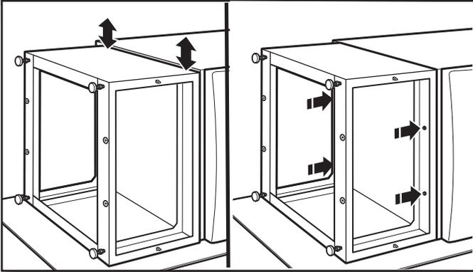
Alinee los lados del pedestal para que coincidan con los lados de la lavadora/secadora. Busque dentro de la abertura del pedestal y ajuste fuertemente los cuatro tornillos de pedestal.
