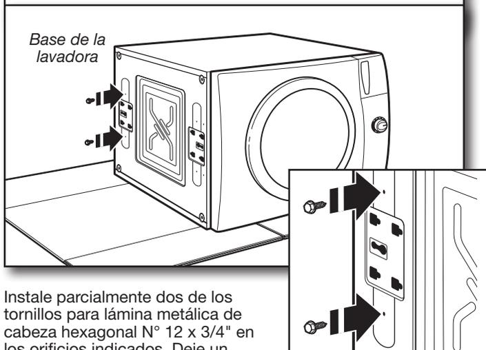
Instale parcialmente dos de los tornillos para lámina metálica de cabeza hexagonal N° 12 x 3/4" en los orificios indicados. Deje un espacio de aproximadamente 3/8" (10 mm) entre la cabeza del tornillo y la parte inferior de la lavadora.
