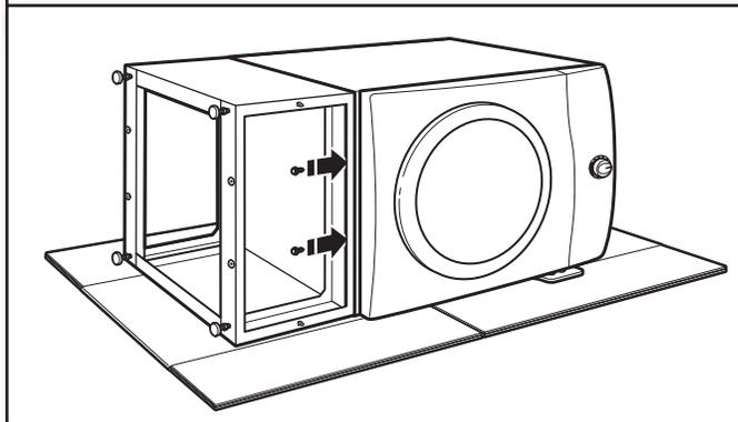
Posicione el pedestal hacia la parte frontal de la secadora e instale los otros dos tornillos para lámina metálica de cabeza hexagonal. No los apriete completamente. Ahora vaya a "Complete la instalación del pedestal".
