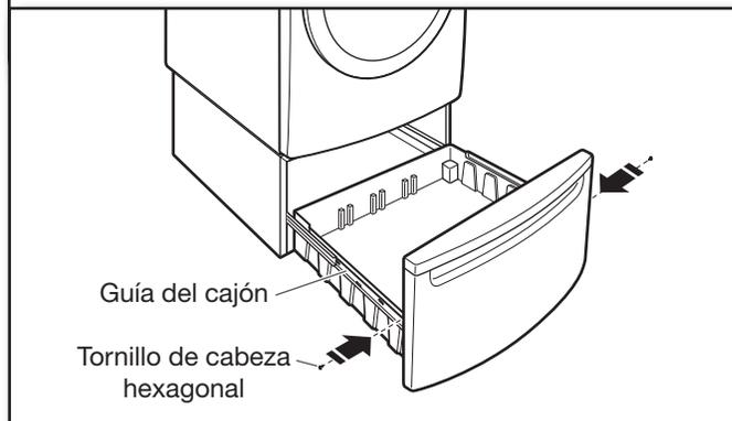
Jale hacia fuera ambas guías del cajón y vuelva a ensamblar el cajón en las guías con los 2 tornillos de cabeza hexagonal.
