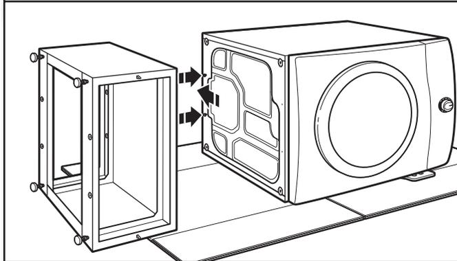
Mueva el pedestal contra la base de la secadora. El frente de la carcasa del pedestal deberá estar alineado con la carcasa de la secadora, como se muestra a continuación.
