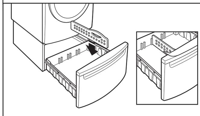
Quite la película de transporte del cajón. Coloque el divisor en el cajón en la ubicación deseada. Cierre el cajón.
