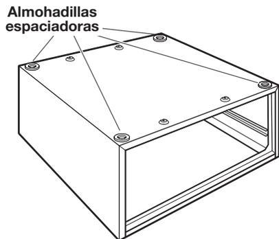
Las cuatro almohadillas espaciadoras están instaladas en la parte superior del pedestal. Estas almohadillas reducen la vibración entre el pedestal y la lavadora/secadora.
