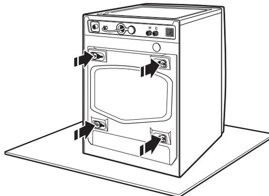
Ubique los pernos de transporte que están en la parte posterior de la lavadora. Los pernos de transporte deberán permanecer en la lavadora antes de poder instalar el pedestal. Para obtener más información acerca de los pernos de transporte, vea "Eliminación del sistema de transporte" en el Manual de uso y cuidado de la lavadora.
