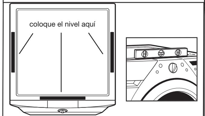
Coloque un nivel en los bordes superiores de la lavadora/secadora, revisando cada lado y el frente. Balancee la lavadora/secadora hacia delante y hacia atrás para asegurarse de que las 4 patas hagan contacto firme con el piso.
