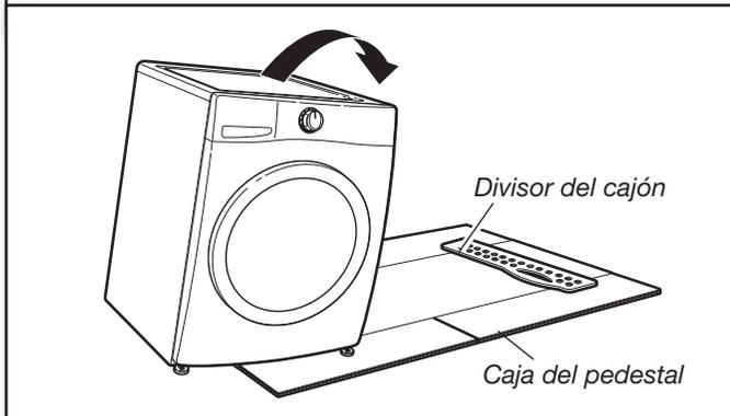
Para evitar daños en el piso y facilitar la instalación y el manejo, despliegue la caja vacía del pedestal para dejarla plana y colóquela al lado de la lavadora. Coloque el divisor del cajón para que quede cerca de la parte superior de la lavadora, como se muestra. Incline con cuidado la lavadora sobre su costado hasta que quede sobre el divisor del cajón.
