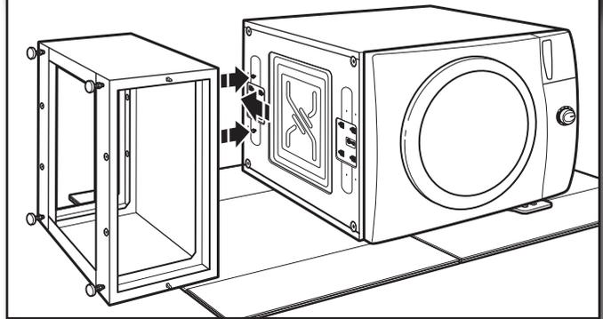
Mueva el pedestal contra la base de la lavadora. El frente de la carcasa del pedestal deberá estar alineado con la carcasa de la lavadora, como se muestra a continuación.
