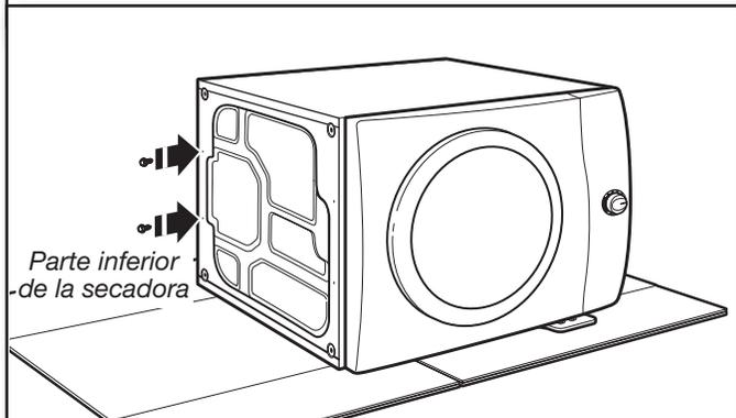
Instale parcialmente dos de los tornillos para lámina metálica de cabeza hexagonal N° 12 x 3/4" en los orificios indicados. Deje un espacio de aproximadamente 3/8" (10 mm) entre la cabeza del tornillo y la parte inferior de la secadora.
