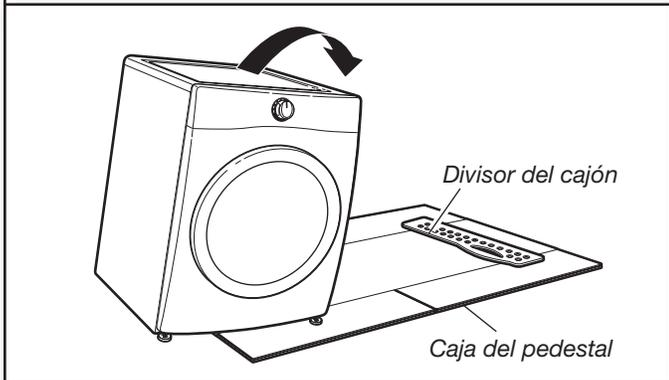
Para evitar daños en el piso y facilitar la instalación y el manejo, despliegue la caja vacía del pedestal para dejarla plana y colóquela al lado de la secadora. Coloque el divisor del cajón para que quede cerca de la parte superior de la secadora, como se muestra. Incline con cuidado la secadora sobre su costado hasta que quede sobre el divisor del cajón.
