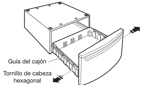
Con una llave de tuercas de 1/4", retire los tornillos de cabeza hexagonal de ambas guías del cajón y guárdelos. Quite el cajón de las guías y déjelo a un lado. Empuje las guías nuevamente hacia dentro del pedestal.
