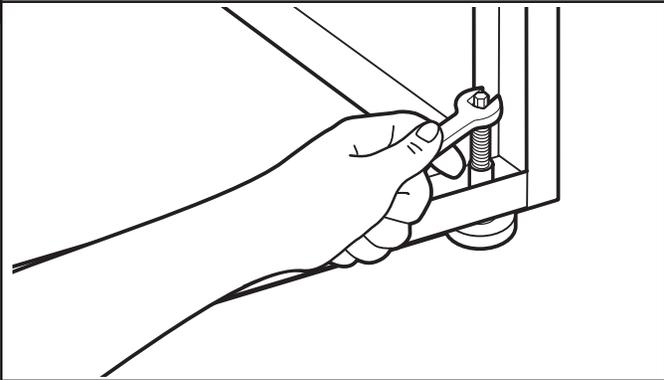
Ubique los tornillos de cabeza hexagonal de 1/4", que están sobre cada pata del pedestal. Busque dentro del pedestal y use un trinquete de cabeza hexagonal o una llave de boca de 1/4" para regular las patas hacia arriba o hacia abajo, según sea necesario, para nivelar la lavadora/secadora.
