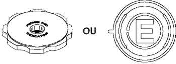
Ou retirer le bouchon du distributeur d'agent de rinçage. Si la lettre "E" est visible, le distributeur est vide.
