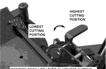
POSITION DECK LIFT LEVER IN HIGHEST CUTTING POSITION. PLACE WOODEN BLOCKS UNDER FRONT AND REAR OF DECK. LOWER DECK ONTO BLOCKS
