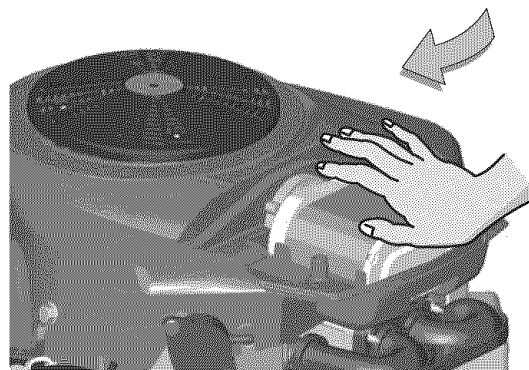
Figura 34. Instalación del filtro de aire A. Cartucho del filtro
