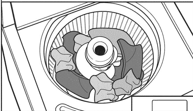
Charger les vêtements sans les tasser et de façon uniforme le long de la paroi du panier. Pour de meilleurs résultats, ne pas remplir au-delà de la hauteur maximale de charge recommandée. Ne pas enrouler de grands articles tels des draps autour de l'agitateur; les charger sans les tasser le long de la paroi du panier. Essayer de mélanger différents types d'articles pour réduire l'emmêlement.
