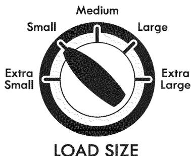
Seleccione el ajuste Load Size (Tamaño de la carga) más adecuado para su carga. El ajuste Extra Small (Extra pequeño) agregará una pequeña cantidad de agua para las cargas pequeñas y el ajuste Extra Large (Extra grande) agregará la mayor cantidad de agua para las cargas grandes o voluminosas. Los artículos deben moverse libremente.
