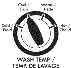
Après avoir sélectionné le volume de la charge, sélectionner Wash Temp (Temp. de lavage) en tournant le bouton à la température souhaitée. Tous les rinçages se font à la température de l'eau froide du robinet.
