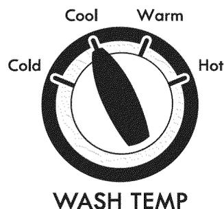
Después de elegir el tamaño de la carga, seleccione WASH TEMP (Temperatura de lavado) girando la perilla a la temperatura deseada. Todos los enjuagues son con agua fría del grifo.
