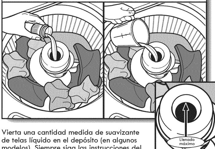
Vierta una cantidad medida de suavizante de telas líquido en el depósito (en algunos modelos). Siempre siga las instrucciones del fabricante para usar la cantidad correcta de suavizante de telas según el tamaño de la carga.
