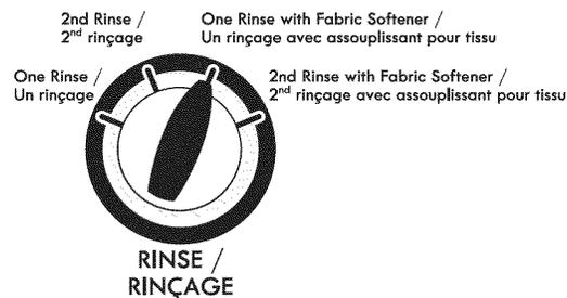
Sélectionner les options désirées. Si l'on utilise de l'assouplissant pour tissu, veiller à sélectionner une des options Rinse with Fabric Softener (rinçage avec assouplissant pour tissu).
