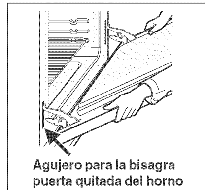
Cierre en posición enganchada, para sacar la puerta
