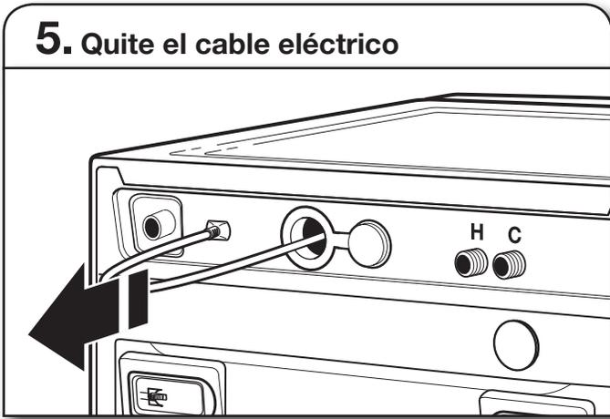
Jale el cable eléctrico a través de la abertura en el panel posterior y cierre el orificio con el tapón provisto.
