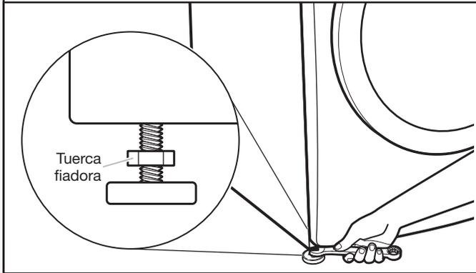
Cuando la lavadora esté nivelada, use una llave de boca o una llave ajustable de 9/16" ó 14 mm para girar las tuercas fijadoras en las patas hacia la izquierda, apretándolas contra la carcasa de la lavadora.
