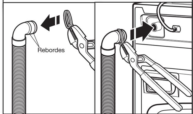
Si la abrazadera no está en su lugar sobre el extremo del codo de la manguera de desagüe, deslícela sobre el extremo de la manguera centrándola entre los rebordes, como se muestra. Apriete la abrazadera con pinzas y deslice el extremo en forma de codo de la manguera de desagüe sobre el puerto de desagüe. Asegúrelo con la abrazadera.
