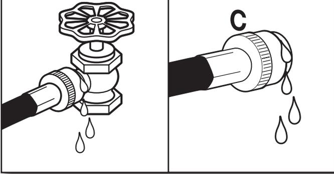
Abra los grifos del agua para revisar si hay fugas de agua en el grifo y en la conexión a la lavadora. Una pequeña cantidad de agua podría entrar en la lavadora. Ésta se desaguará más tarde.
