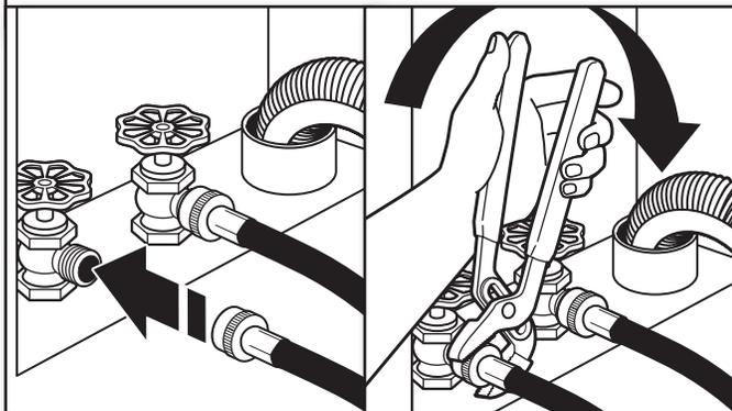
Sujete la manguera al grifo de agua caliente. Atornille el acoplamiento con la mano hasta que quede asentado en la lavadora. Use pinzas para apretar los acoplamientos dos tercios de vuelta adicional. Repita este paso con la segunda manguera para el grifo de agua fría.
