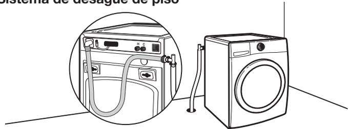
Un sistema de desagüe por el piso requiere de un juego de desviación de sifón (pieza número 285834), 2 juegos de conectores (pieza número 285385) y extensión de manguera de desagüe (pieza número 285863), la cual puede comprarse por separado. Vea "Piezas alternativas". Desviación de sifón mínima: 28" (710 mm) de la base de la lavadora. (Se pueden necesitar mangueras adicionales.)
