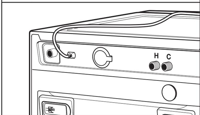
Quite el fleje de embalaje amarillo del cable. Coloque el cable eléctrico con cuidado sobre la parte superior de la lavadora para permitir un acceso sin obstrucciones a la parte posterior de la misma.
