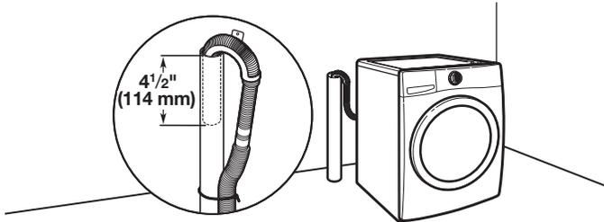
Diámetro mínimo para el desagüe de tubo vertical: 2" (51 mm)
