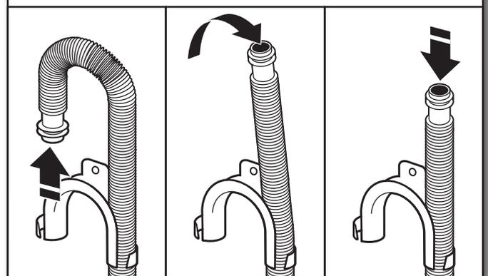
Para las instalaciones con desagüe por el piso, necesitará quitar el molde de la manguera de desagüe del extremo de la misma. Puede ser que necesite piezas adicionales con instrucciones por separado. Vea "Piezas alternativas".
