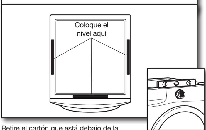
Retire el cartón que está debajo de la lavadora. Coloque un nivel en los bordes superiores de la lavadora, revisando cada lado y el frente. Si la lavadora no está nivelada, inclínela y ajuste las patas hacia arriba o hacia abajo, como se muestra en los pasos 17 y 18, repitiendo si es necesario.
