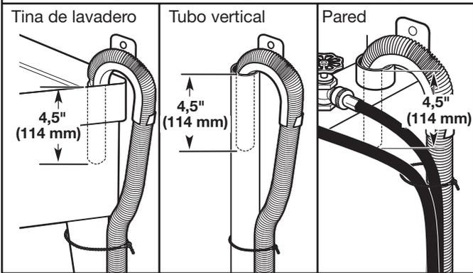
Asegure la manguera de desagüe a la pata del lavadero, al tubo vertical o a las mangueras de entrada para el tubo vertical de pared, utilizando la atadura de cables.
