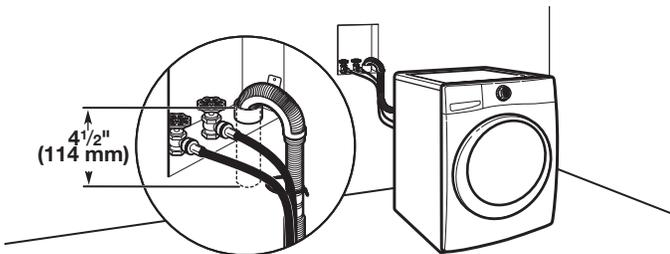
Vea los requisitos para el sistema de desagüe de tubo vertical de piso.
