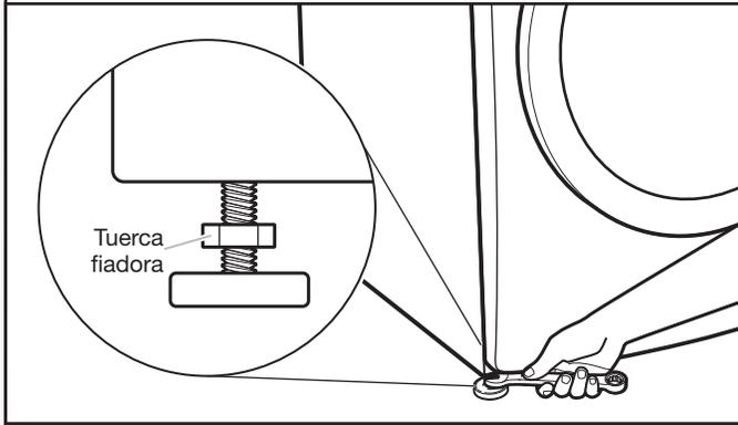
Si la lavadora no está nivelada, use una llave de boca o una llave ajustable de 9/16" ó 14 mm para girar las tuercas fijadoras hacia la derecha sobre las patas, hasta que estén a aproximadamente 1/2" (13 mm) de la carcasa de la lavadora. Luego gire la pata niveladora hacia la derecha para bajar la lavadora, o hacia la izquierda para levantarla. Vuelva a verificar la nivelación de la lavadora y que las cuatro patas estén en contacto firme con el piso. Repita el procedimiento si es necesario.
