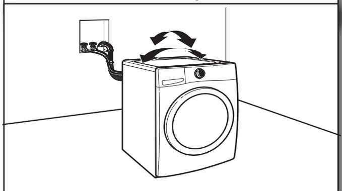
Sujete la lavadora de la parte superior y balancéela de atrás hacia delante, asegurándose de que las 4 patas estén firmes en el piso. Repítalo, balanceando la lavadora de un lado al otro. Si se balancea la lavadora, vaya al paso 17 y regule las patas niveladoras. Si las cuatro patas hacen contacto firme con el piso, vaya al paso 18.
