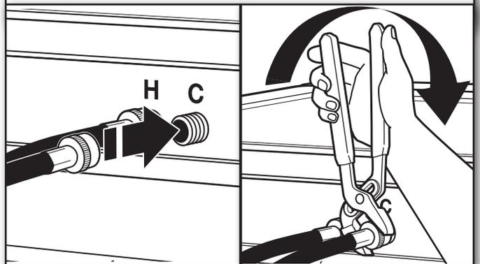
Sujete la manguera de agua caliente a la válvula de entrada del agua caliente, marcada con un anillo rojo. Atornille el acoplamiento a mano hasta que quede apretado. Use pinzas para apretar los acoplamientos dos tercios de vuelta adicional. Repítalo con la válvula de entrada del agua fría.
