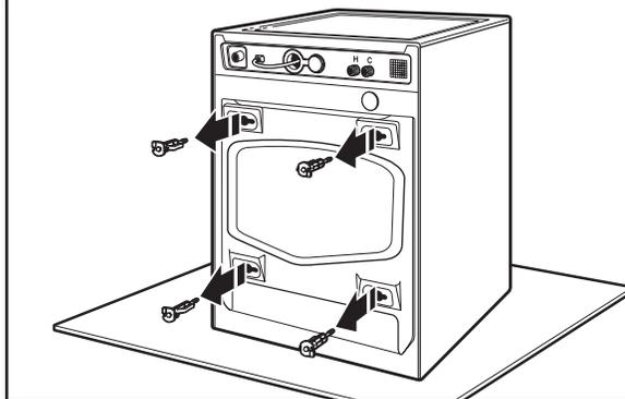
Aflove los pernos con una llave de tuercas de 1/2" (13 mm). Deslice cada perno y el espaciador hacia el centro del orificio. Jale los pernos y los espaciadores de plástico de la parte posterior de la lavadora. Deshágase de los pernos y los espaciadores.
