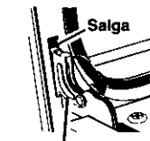
Salga Cerradura de bisagra Tire de los cierres de la bisagra hacia abajo para abrir
