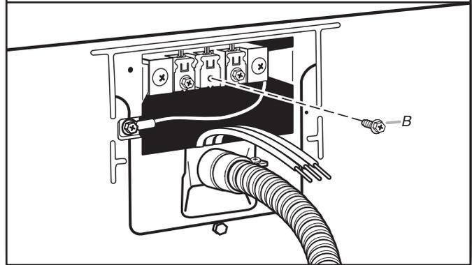
Saque el tornillo central del bloque de terminal (B).
