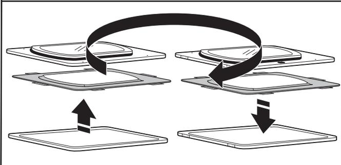
Gire la puerta exterior 180° y colóquela de nuevo sobre la puerta interior. Vuelva a sujetar el panel exterior al panel interior de la puerta, de modo que la manija quede en el lado en donde recién se han quitado las bisagras. Inserte los 4 tornillos de la puerta.
