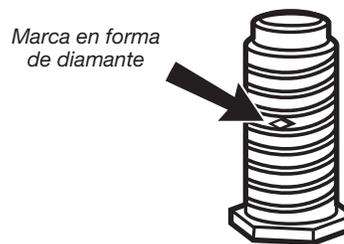
Examine las patas niveladoras; localice la marca en forma de diamante. Atornille con la mano las patas en los orificios de las mismas y use una llave de tuercas para terminar de atornillar las patas hasta que la marca en forma de diamante no quede visible.
