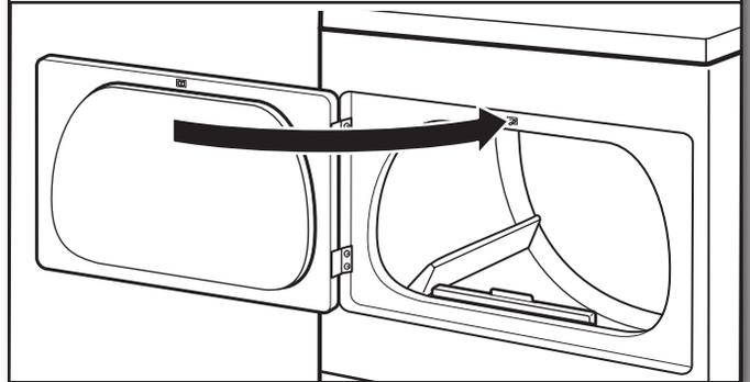
Cierre la puerta y verifique que el tope de la misma esté alineado con el seguro de la puerta. De ser necesario, deslice el seguro de la puerta hacia la izquierda o derecha dentro de la ranura para ajustar el alineamiento.
