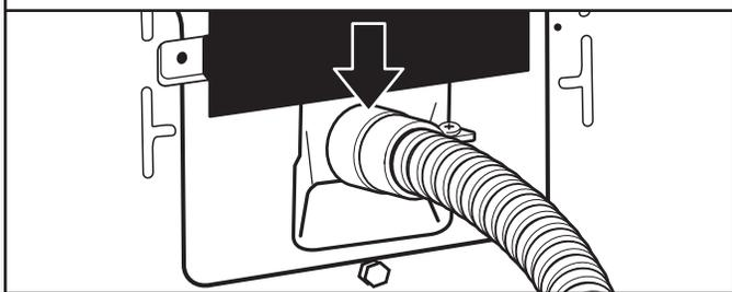
Haga pasar el cable directo a través del protector de cables. El protector de cables deberá encajar bien con la carcasa de la secadora y estar en posición horizontal. Apriete el tornillo del protector de cables contra el cable directo.
