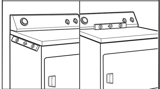
Revise la nivelación de la secadora de lado a lado. Repita el procedimiento de adelante hacia atrás.
