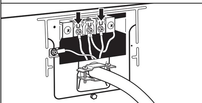
Conecte los hilos restantes a los tornillos externos del bloque de terminal. Apriete los tornillos. Por último vuelva a insertar la lengüeta de la tapa del bloque de terminal dentro de la ranura del panel posterior de la secadora. Asegure la tapa con un tornillo de sujeción. Ahora vaya a "Requisitos de ventilación".
