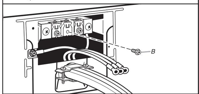
Saque el tornillo central del bloque de terminal (B).
