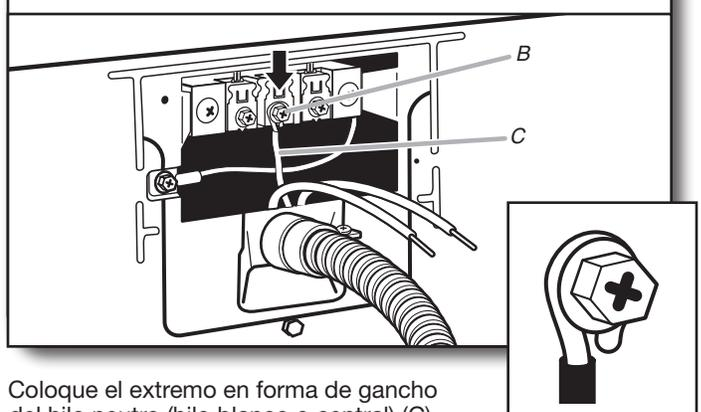
Coloque el extremo en forma de gancho del hilo neutro (hilo blanco o central) (C) del cable directo debajo del tornillo central (B) del bloque de terminal. Apriete y junte el extremo en forma de gancho. Apriete el tornillo.
