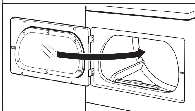
Cierre la puerta y verifique que el tope de la misma esté alineado con el seguro de la puerta. De ser necesario, deslice el seguro de la puerta hacia la izquierda o derecha dentro de la ranura para ajustar el alineamiento.
