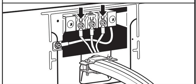
Conecte los hilos restantes a los tornillos externos del bloque de terminal. Apriete los tornillos. Por último vuelva a insertar la lengüeta de la tapa del bloque de terminal dentro de la ranura del panel posterior de la secadora. Asegure la tapa con un tornillo de sujeción. Ahora vaya a "Requisitos de ventilación".
