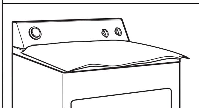
Coloque una toalla encima de la secadora para evitar dañar la superficie.
