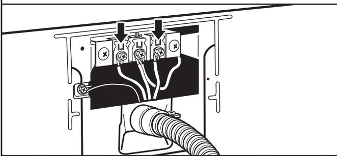
Coloque los extremos en forma de gancho de los hilos restantes del cable de conexión directa debajo de los tornillos exteriores del bloque de terminal (con los ganchos mirando hacia la derecha). Apriete los extremos en forma de gancho y apriete los tornillos. Por último vuelva a insertar la lengüeta de la tapa del bloque de terminal dentro de la ranura del panel posterior de la secadora. Asegure la tapa con un tornillo de sujeción. Ahora vaya a "Requisitos de ventilación".
