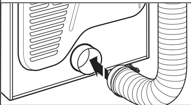
Usando una abrazadera de 4" (102 mm), conecte el ducto de escape a la salida de aire de la secadora. Si se conecta a un ducto de escape existente, asegúrese de que el mismo esté limpio. El ducto de escape de la secadora debe encajar sobre la salida de aire de la secadora y dentro de la capota de ventilación. Cerciórese de que el ducto de escape esté asegurado a la capota de ventilación con una abrazadera de 4" (102 mm).
