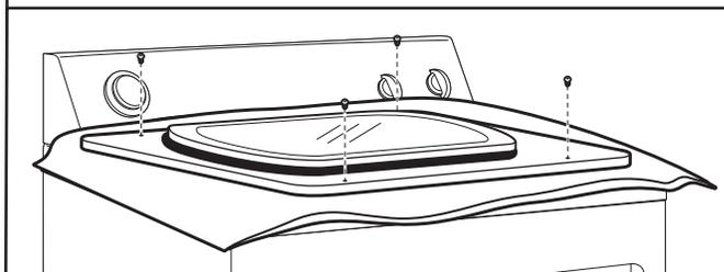
Quite los tornillos de la parte superior, inferior y lateral de la puerta (4 tornillos). Mantenga los tornillos de la puerta separados de los tornillos de la bisagra, ya que son de distintos tamaños.
