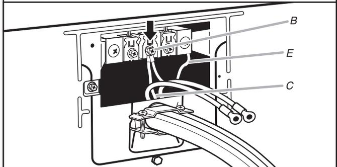
Conecte hilo neutro de tierra (E) y el hilo neutro (C) (hilo blanco o central) del cable de suministro eléctrico, debajo del tornillo central del bloque de terminal (B). Apriete el tornillo.
