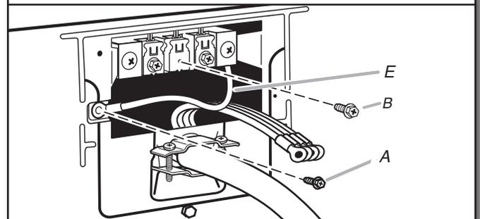
Saque el tornillo central del bloque de terminal (B). Saque el hilo neutro de puesta a tierra (E) del tornillo conductor a tierra externo (A).
