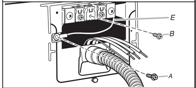
Saque el tornillo central del bloque de terminal (B). Saque el hilo de tierra neutro (E) del tornillo conductor de tierra externo (A).
