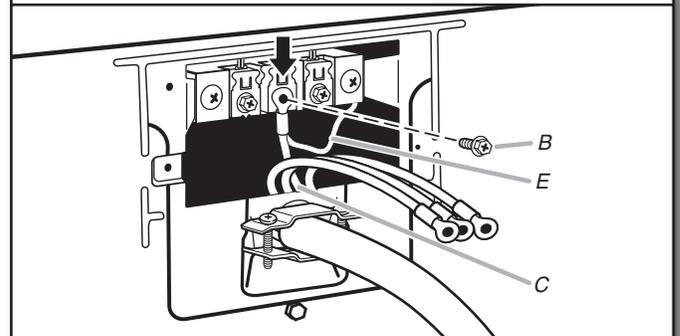
Conecte el hilo neutro de puesta a tierra (E) y el hilo neutro (C) (hilo blanco o central) del cable de suministro de energía debajo del tornillo central del bloque de terminal (B). Apriete el tornillo.
