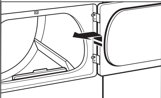
Levante la puerta hasta que los tornillos superiores de la carcasa de la secadora estén en la parte grande de la ranura de la bisagra. Jale la puerta hacia adelante para separarla de los tornillos. Coloque la puerta (con el lado de la manija hacia arriba) encima de la secadora. Extraiga los tornillos superiores de la carcasa de la secadora.
