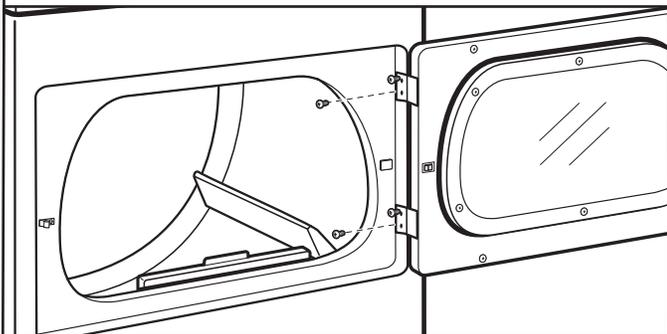
Abra la puerta de la secadora. Extraiga los tornillos inferiores de las bisagras del lado de la carcasa. Afloje (no extraiga) los tornillos superiores de las bisagras del lado de la carcasa.
