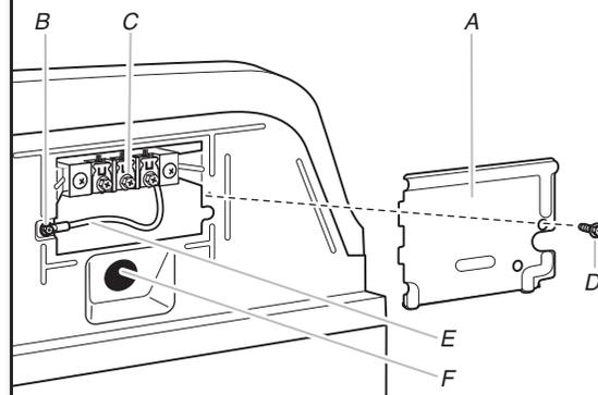
Desconecte el suministro de energía antes de comenzar. Quite el tornillo de sujeción (D) y la cubierta de la caja de terminal (A).
