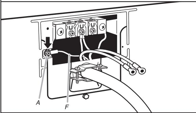
Conecte el hilo de tierra (F) (verde o desnudo) del cable de suministro eléctrico al tornillo conductor de tierra externo (A). Apriete el tornillo.
