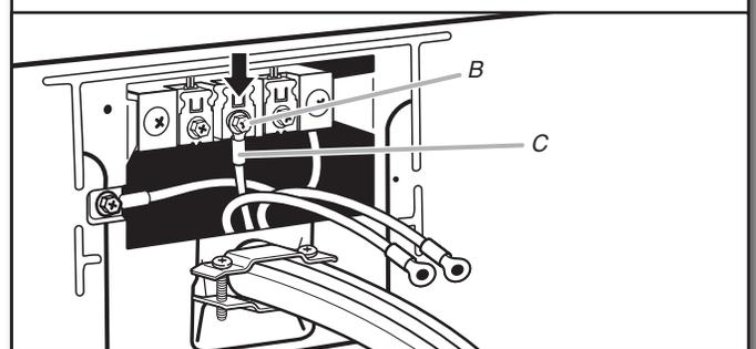
Conecte el hilo neutro (C) (hilo blanco o central) del cable de suministro eléctrico al tornillo central (B) del bloque de terminal. Apriete el tornillo.
