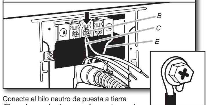
Conecte el hilo neutro de puesta a tierra (E) y coloque el extremo en forma de gancho (gancho mirando hacia la derecha) del hilo neutro (C) (blanco o central), del cable de conexión directa, debajo del tornillo central del bloque de terminal (B). Apriete y junte los extremos en forma de gancho. Apriete el tornillo.
