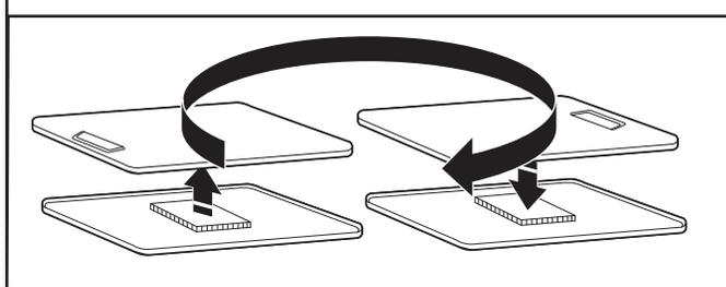
Gire la puerta exterior 180° y colóquela de nuevo sobre la puerta interior. Vuelva a sujetar el panel exterior al panel interior de la puerta, de modo que la manija quede en el lado en donde recién se han quitado las bisagras. Inserte los 5 tornillos de la puerta.
