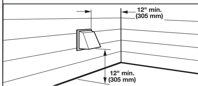
Instale la capota de ventilación y use compuesto para calafateo para sellar la abertura exterior de la pared alrededor de la capota de ventilación.
