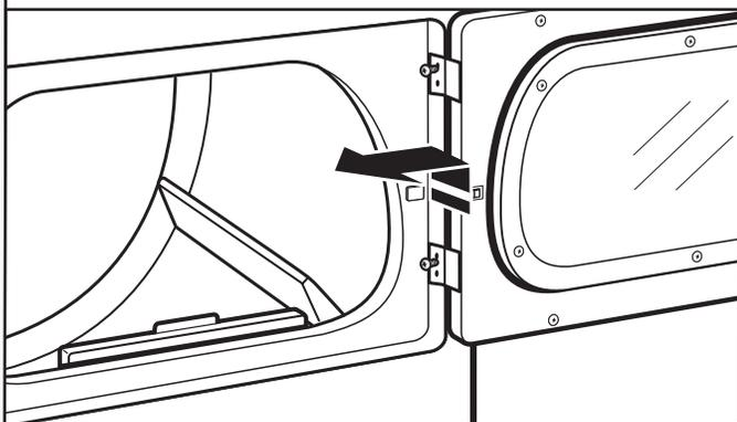
Levante la puerta hasta que los tornillos inferiores de la carcasa estén en la parte grande de la ranura de la bisagra. Tire de la puerta hacia adelante para separarla de los tornillos. Coloque la puerta (con el lado de la manija hacia arriba) encima de la secadora. Extraiga los tornillos superiores de la carcasa.
