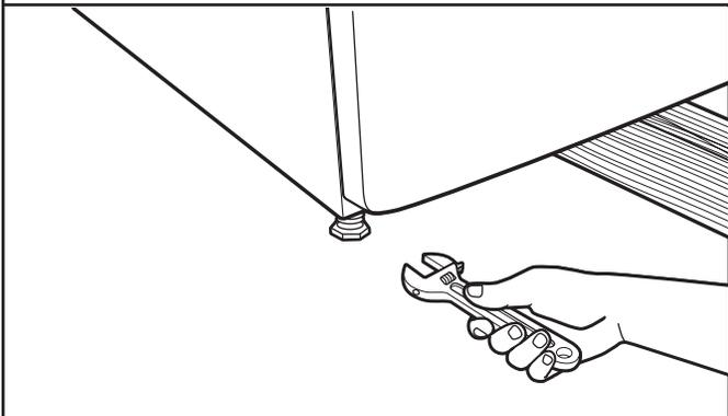
Si la secadora no está nivelada, levántela colocando un bloque de madera debajo de la misma, use una llave de tuercas para regular las patas hacia arriba o hacia abajo y revise nuevamente si está nivelada. Una vez que la secadora está nivelada, cerciórese de que las cuatro patas estén ajustadas contra el suelo antes de apretarlas.
