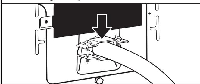
Haga pasar el cable de suministro de energía a través del protector de cables. Asegúrese de que el aislamiento de cables del cable de suministro de energía esté dentro del protector de cables. El protector de cables deberá encajar bien con la carcasa de la secadora y estar en posición horizontal. No ajuste más los tornillos del protector de cables en este momento.
