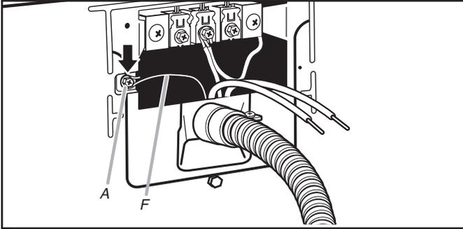
Conecte el hilo de tierra (F) (verde o desnudo) del cable directo de suministro eléctrico al tornillo del conductor de tierra externo (A). Apriete el tornillo.
