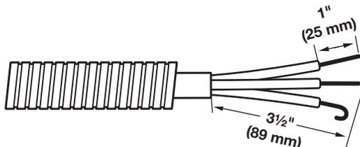
El cable de conexión directa debe tener 5 pies (1,52 m) extra de largo para poder mover la secadora si fuese necesario.
