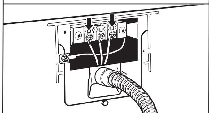
Coloque los extremos en forma de gancho de los hilos restantes del cable de conexión directa debajo de los tornillos exteriores del bloque de terminal (con los ganchos mirando hacia la derecha). Apriete los extremos en forma de gancho y apriete los tornillos. Por último vuelva a insertar la lengüeta de la tapa del bloque de terminal dentro de la ranura del panel posterior de la secadora. Asegure la tapa con un tornillo de sujeción. Ahora vaya a "Requisitos de ventilación".
