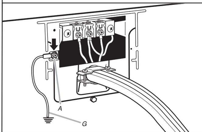
Conecte un hilo a tierra de cobre separado (G) desde el tornillo conductor a tierra externo (A) a una conexión a tierra adecuada. Por último vuelva a insertar la lengüeta de la tapa del bloque de terminal dentro de la ranura del panel posterior de la secadora. Asegure la tapa con un tornillo de sujeción. Ahora vaya a "Requisitos de ventilación".
