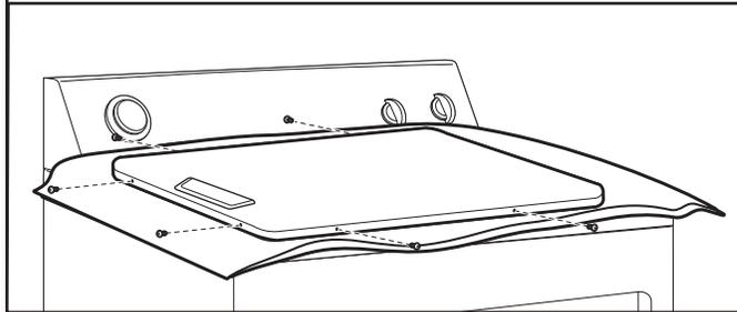
Quite los tornillos de la parte superior, inferior y lateral de la puerta (6 tornillos). Mantenga los tornillos de la puerta separados de los tornillos de la bisagra, ya que son de distintos tamaños. Sosteniendo la puerta sobre la toalla encima de la secadora, sujete los lados de la puerta exterior y levántela para separarla de la puerta interior.
