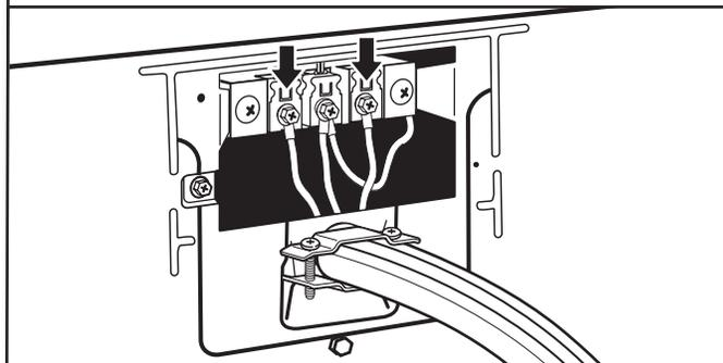
Coloque los extremos en forma de gancho de los hilos restantes debajo de los tornillos exteriores del bloque de terminal (con los ganchos mirando hacia la derecha). Apriete los tornillos.
