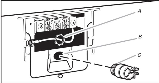
Desatornille el conector de conducto removible (A) y cualquier tornillo del protector de cables de 3/4" (19 mm) que esté en la lista de UL (con la marca UL en el protector de cables). Haga pasar la sección roscada del protector de cables (C) a través del orificio que está debajo de la abertura del bloque de terminal (B). Busque dentro de la abertura del bloque de terminal y atornille el conector de conducto removible (A) sobre las roscas del protector de cables.
