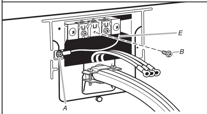
Saque el tornillo central del bloque de terminal (B). Saque el hilo de tierra neutro (E) del tornillo conductor de tierra externo (A).
