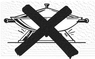
N'utilisez pas de wok à fond plat sur un anneau de support. Placer l'anneau sur le brûleur ou la grille pourrait provoquer un mauvais fonctionnement du brûleur, menant à des niveaux de monoxyde de carbone au-dessus des normes permises. Ceci pourrait être dangereux pour votre santé.
