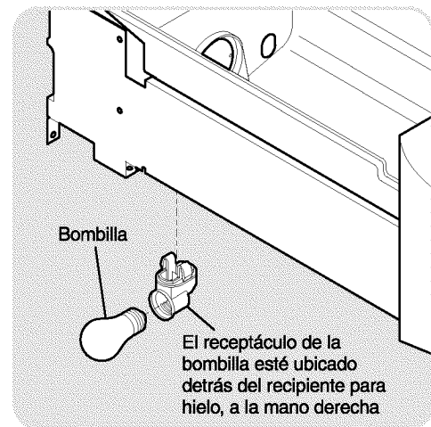
Reemplazo de la bombilla del congelador
