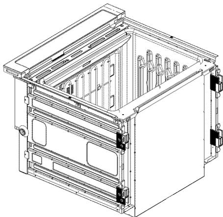
2. Retirer le pied de la cale d'espacement avant droite en ôtant la vis n° 8-18 x 3/8".
