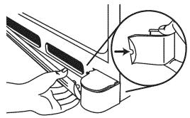
3. À l'aide d'un tournevis ou d'un tournevis à tête hexagonale de %", tourner la vis de réglage des roulettes de chaque côté pour soulever ou abaisser ce côté du réfrigérateur.
