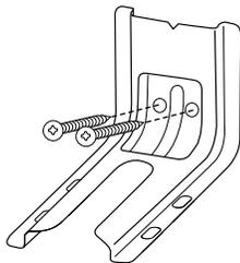
5. À l'aide du tournevis Phillips, monter la bride antibasculement sur le mur ou sur le plancher avec les deux vis n° 12 x  $1\frac{1}{8}$ " fournies.
