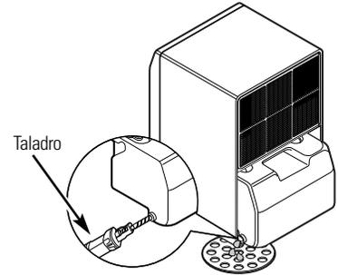
**NOTA:** Una boquilla perforada no podrÁ repararse despuÓs de la perforaciÓn. Use un tapÓn con rosca de manguera de jardÍn si es necesario taparlo (no incluido).
