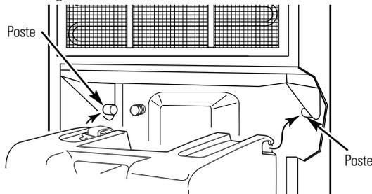
CerciÓrese que el tanque quede asegurado en su lugar presionando hacia abajo el borde superior del tanque. El tanque quedarÁ firmemente asentada cuando estÓ instalado apropiadamente.
