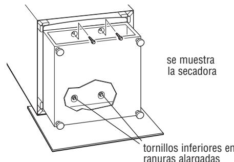
**6.** Incorpore la lavadora/secadora nuevamente a la posición vertical. Quite y descarte los materiales de embalaje incluyendo la película de plástico de la lavadora, los postes esquineros y la cubierta superior.
