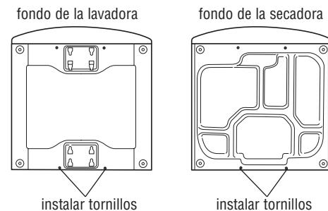
5. Mueva el pedestal acercándolo al fondo de la lavadora/secadora. Deslice las ranuras alargadas del pedestal sobre los dos tornillos parcialmente instalados.
