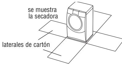
2. Coloque la lavadora/secadora en el piso sobre su respaldo.
