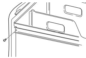
3. Si su lavadora/secadora tiene las patas instaladas, retírelas. No instale las patas que vinieron con la nueva lavadora/secadora.
