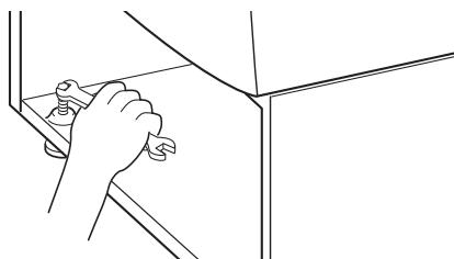
**10.** Cuando la lavadora/secadora esté nivelada, use una llave de tuercas de 9/16" (14.3 mm) de extremo abierto para apretar firmemente las contratuerca de las cuatro patas contra el pedestal. Las contratuerca deben ser apretadas.
