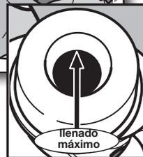
Vierta una cantidad medida de suavizante de telas líquido en el depósito. Siempre siga las instrucciones del fabricante para usar la cantidad correcta de suavizante de telas según el tamaño de la carga.
