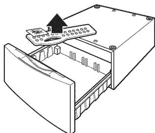
2. Vérifier que les quatre cales d'espacement sont installées sur la partie supérieure du piédestal.
