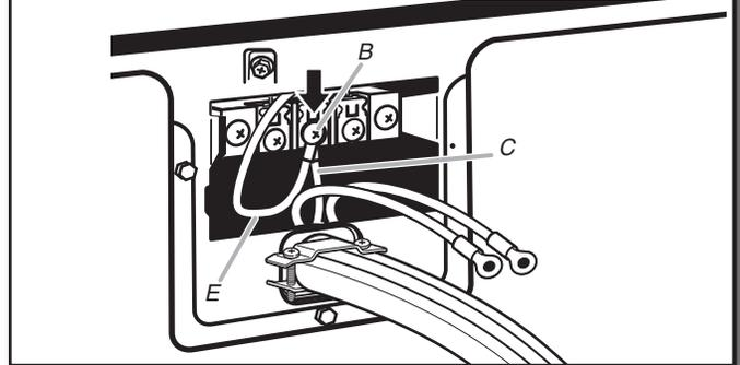
Conecte hilo neutro a tierra (E) y el hilo neutro (hilo blanco o central) (C) del cordón/cable de suministro eléctrico debajo del tornillo central del bloque de terminal (B). Apriete el tornillo.
