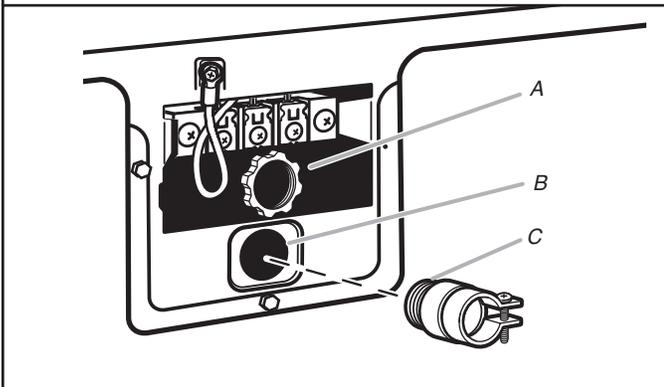
Desatornille el conector de conducto removible (A) y cualquier tornillo del protector de cables de 3/4" (19 mm) que está en la lista de UL (con la marca UL en el protector de cables). Haga pasar la sección trenzada del protector de cables a través del orificio (B) que está debajo de la abertura del bloque de terminal. Busque dentro de la abertura del bloque de terminal y atornille el conector de conducto removible sobre las roscas del protector de cables (C).
