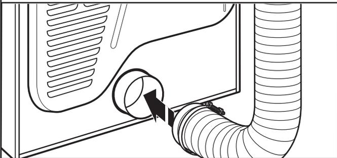
Usando una abrazadera de 4" (102 mm), conecte el ducto de escape a la salida de aire de la secadora. Si se conecta a un ducto de escape existente, asegúrese de que el mismo esté limpio. El ducto de escape de la secadora debe encajar sobre la salida de aire de la secadora y dentro de la capota de ventilación. Cerciórese de que el ducto de escape esté asegurado a la capota de ventilación con una abrazadera de 4" (102 mm).
