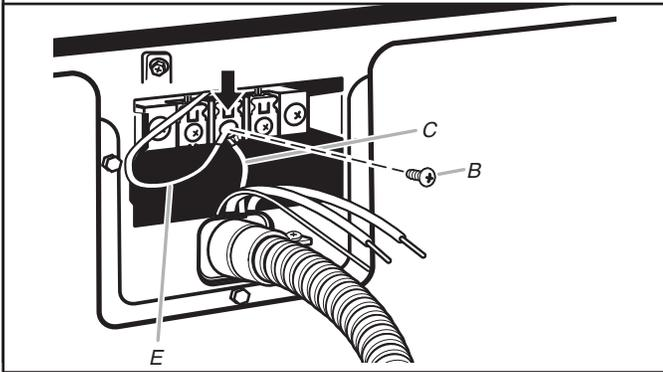
Conecte el hilo neutro de puesta a tierra (E) y coloque el extremo en forma de gancho (gancho mirando hacia la derecha) del hilo neutro (C) (blanco o central) del cable de conexión directa debajo del tornillo central del bloque de terminal (B). Apriete y junte los extremos en forma de gancho. Apriete el tornillo.
