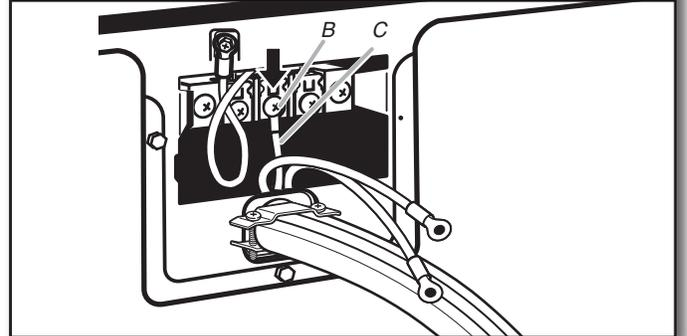
Conecte el hilo neutro (hilo blanco o central) (C) del cable de suministro de energía al tornillo central del bloque de terminal (B). Apriete el tornillo.
