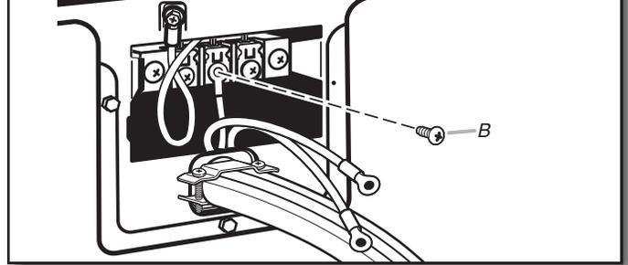
Saque el tornillo central del bloque de terminal (B).
