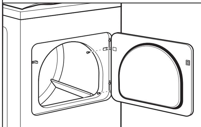
Abra la puerta de la secadora. Extraiga los tornillos inferiores de las bisagras del lado de la carcasa. Afloje (no extraiga) los tornillos superiores de las bisagras del lado de la carcasa de la secadora.
