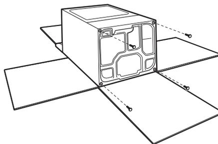
Para evitar daños en el piso, use un pedazo de cartón grande y plano de la caja de la secadora; colóquelo debajo de todo el borde posterior de la secadora. Agarre con firmeza el cuerpo de la secadora (no el panel de la consola) y coloque la secadora suavemente sobre el cartón.
