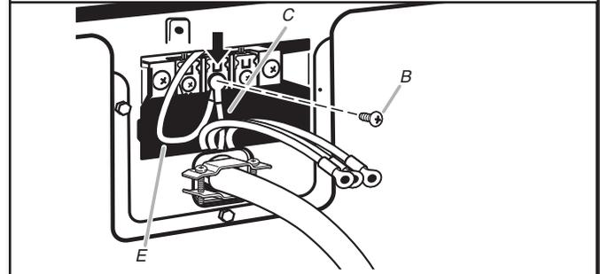
Conecte el hilo neutro de puesta a tierra (E) y el hilo neutro (hilo blanco o central) (C) del cable de suministro de energía debajo del tornillo central del bloque de terminal (B). Apriete el tornillo.
