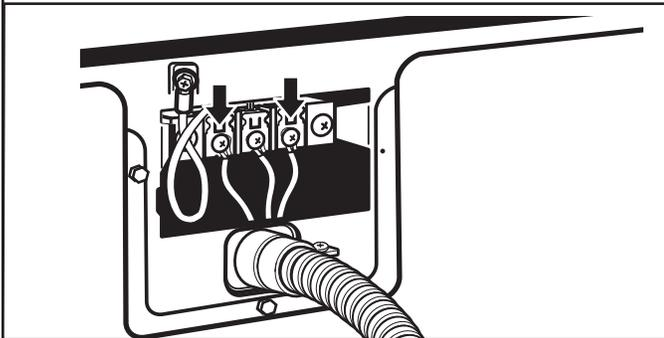
Coloque los extremos en forma de gancho de los hilos restantes del cable directo debajo de los tornillos exteriores del bloque de terminal (con los ganchos mirando hacia la derecha). Apriete los extremos en forma de gancho y apriete los tornillos. Por último vuelva a insertar la lengüeta de la tapa del bloque terminal dentro de la ranura del panel posterior de la secadora. Asegure la tapa con un tornillo de sujeción. Ahora vaya a Requisitos de ventilación.
