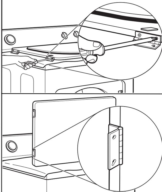
Fije las bisagras de la puerta a la puerta de la secadora, de manera que el orificio más grande quede en la parte inferior de la bisagra.
