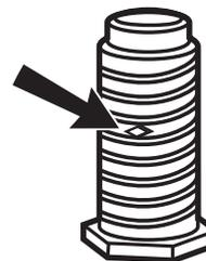
Examine las patas niveladoras; localice la marca en forma de diamante. Atornille con la mano las patas en los orificios de las mismas y use una llave de tuercas para terminar de atornillar las patas hasta que la marca en forma de diamante no quede visible.
