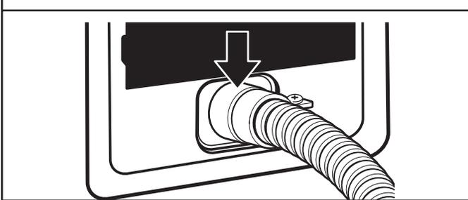
Haga pasar el cable directo a través del protector de cables. El protector de cables deberá encajar bien con la carcasa de la secadora y estar en posición horizontal. Apriete los tornillos del protector de cables.
