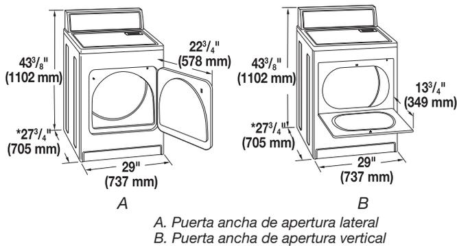
\*La mayoría de las instalaciones requieren un espacio mínimo de 5½" (140 mm) detrás de la secadora para acomodar el ducto de escape con codo. Vea "Requisitos de ventilación".
