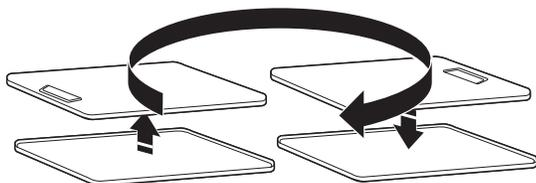
Gire la puerta exterior 180° y colóquela de nuevo sobre la puerta interior. Vuelva a sujetar el panel exterior al panel interior de la puerta, de modo que la manija quede en el lado en donde recién se han quitado las bisagras. Inserte los 4 tornillos de la puerta.
