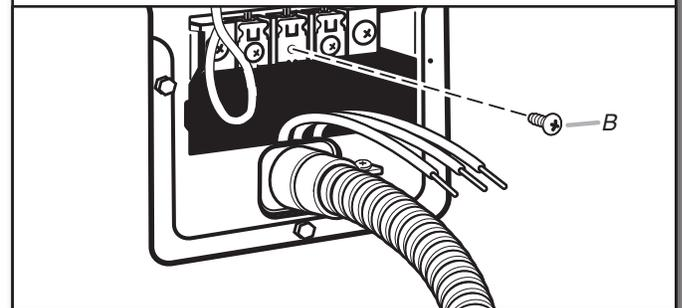
Saque el tornillo central del bloque de terminal (B).
