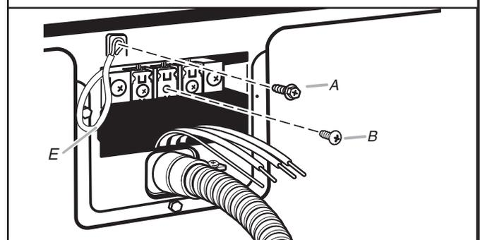
Saque el tornillo central del bloque de terminal (B). Saque el hilo de tierra neutro (E) del tornillo conductor de tierra externo (A).
