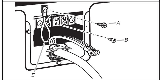
Saque el tornillo central del bloque de terminal (B). Saque el hilo neutro de puesta a tierra (E) del tornillo conductor a tierra externo (A).
