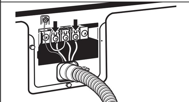
Coloque los extremos en forma de gancho de los hilos restantes del cable directo debajo de los tornillos exteriores del bloque de terminal (con los ganchos mirando hacia la derecha). Apriete los extremos en forma de gancho y apriete los tornillos. Por último vuelva a insertar la lengüeta de la tapa del bloque de terminal dentro de la ranura del panel posterior de la secadora. Asegure la tapa con un tornillo de sujeción. Ahora vaya a Requisitos de ventilación.
