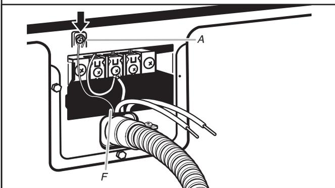
Conecte el hilo a tierra (verde o desnudo) (F) del cable directo al tornillo del conductor de tierra externo (A). Apriete el tornillo.
