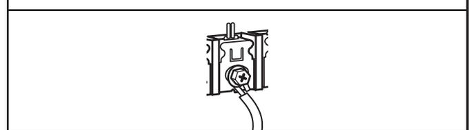
Para conectar los hilos al bloque de terminal, coloque el extremo del hilo en forma de gancho debajo del tornillo del bloque de terminal, mirando hacia la derecha; apriete el extremo en forma de gancho y apriete el tornillo.
