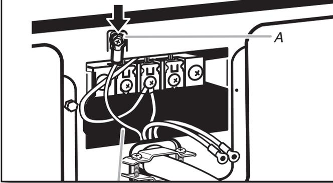
Conecte el hilo de tierra (F) (verde o desnudo) del cable de suministro eléctrico al tornillo conductor de tierra externo (A). Apriete el tornillo.
