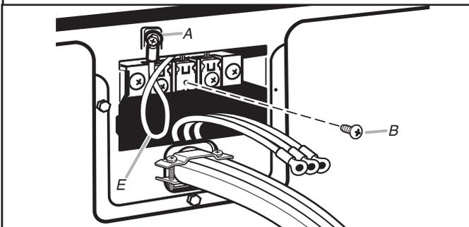
Saque el tornillo central del bloque de terminal (B). Saque el hilo de tierra neutro (E) del tornillo conductor de tierra externo (A).
