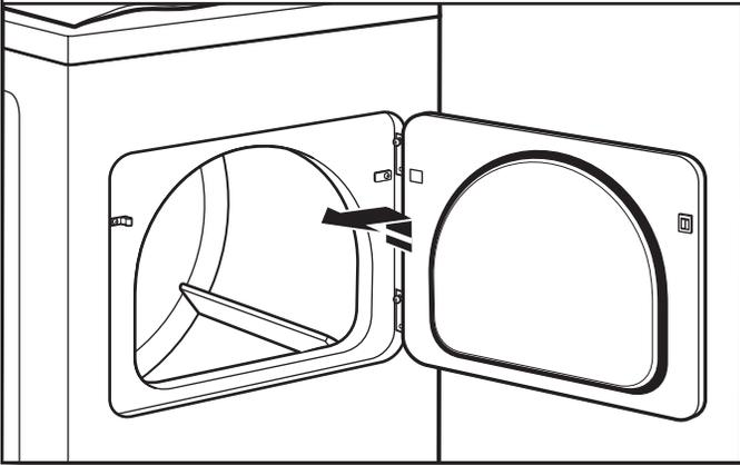
Levante la puerta hasta que los tornillos superiores de la carcasa estén en la parte grande de la ranura de la bisagra. Jale la puerta hacia adelante para separarla de los tornillos. Coloque la puerta (con el lado de la manija hacia arriba) encima de la secadora. Extraiga los tornillos superiores de la carcasa de la secadora.
