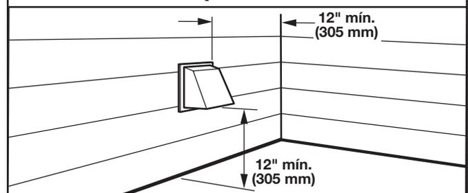
Instale la capota de ventilación y use compuesto para calafateo para sellar la abertura exterior de la pared alrededor de la capota de ventilación.
