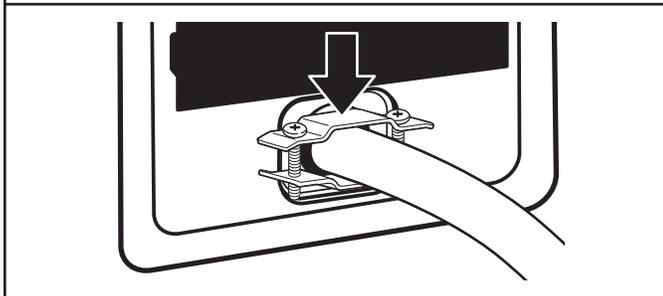
Haga pasar el cable de suministro de energía a través del protector de cables. Asegúrese de que el aislamiento de cables del cable de suministro de energía esté dentro del protector de cables. El protector de cables deberá encajar bien con la carcasa de la secadora y estar en posición horizontal. No ajuste más los tornillos del protector de cables en este momento.
