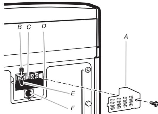
Desconecte el suministro de energía antes de comenzar. Quite el tornillo de sujeción (D) y la cubierta de la caja de terminal (A).
