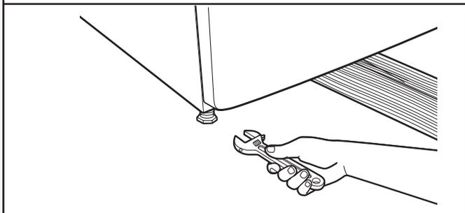
Si la secadora no está nivelada, levántela colocando un bloque de madera debajo de la misma, use una llave de tuerca para regular las patas hacia arriba o hacia abajo y revise nuevamente si está nivelada. Una vez que las patas estén niveladas, cerciórese de que las cuatro patas estén ajustadas contra el suelo antes de apretarlas.
