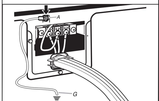
Conecte un hilo a tierra de cobre separado (G) desde el tornillo conductor a tierra externo (A) a una conexión a tierra adecuada. Por último vuelva a insertar la lengüeta de la tapa del bloque de terminal dentro de la ranura del panel posterior de la secadora. Asegure la tapa con un tornillo de sujeción. Ahora vaya a Requisitos de ventilación.
