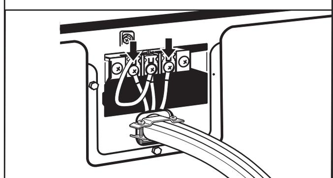
Coloque los extremos en forma de gancho de los hilos restantes debajo de los tornillos exteriores del bloque de terminal (con los ganchos mirando hacia la derecha). Apriete los tornillos.
