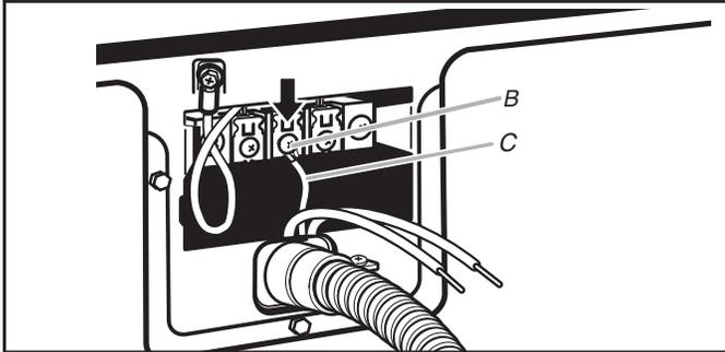
Coloque el extremo en forma de gancho del hilo neutro (hilo blanco o central) (C) del cable directo debajo del tornillo central (B) del bloque de terminal. Apriete y junte el extremo en forma de gancho. Apriete el tornillo.
