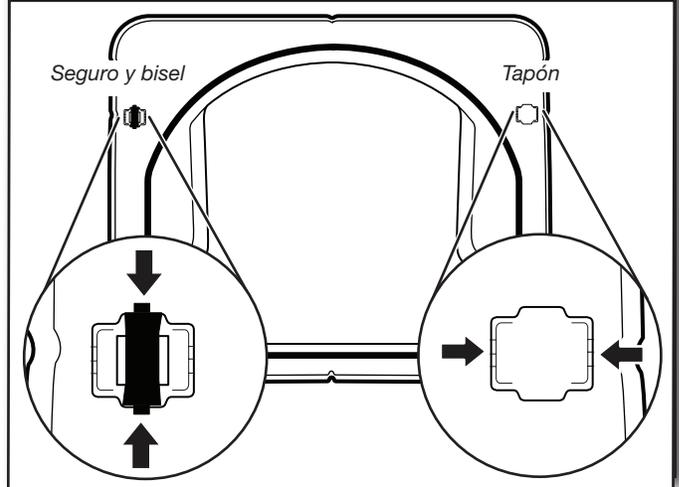
Quite el seguro, el bisel y el tapón de la parte posterior de la puerta interior apretando y jalándolos/empujándolos. Coloque el seguro, el bisel y el tapón de la puerta del otro lado.
