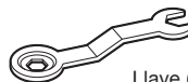
Llave (para sacar los pernos de embalaje y ajustar las patas niveladoras)
