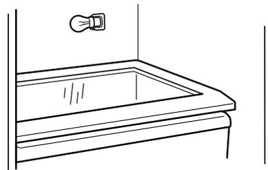
4. Remplacer le protecteur de l'ampoule en saisissant le centre supérieur du protecteur et en insérant les languettes à une extrémité dans les fentes sur la surface interne du réfrigérateur. Ensuite plier délicatement le protecteur au centre pour insérer les languettes à l'autre extrémité.
