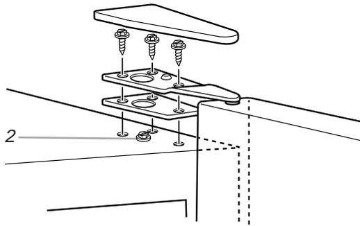
5. Enlever la charnière inférieure si nécessaire. Les deux charnières à la base ont une construction semblable. **NE PAS ENLEVER LA VIS 3 TEL QU'ILLUSTRÉ DANS LE SCHÉMA.**
