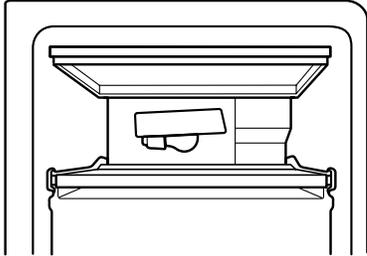
4. Remplacer le protecteur de l'ampoule en saisissant le centre supérieur du protecteur et en insérant les languettes à une extrémité dans les fentes sur la surface interne du réfrigérateur. Ensuite, plier délicatement le protecteur au centre pour insérer les languettes à l'autre extrémité.
