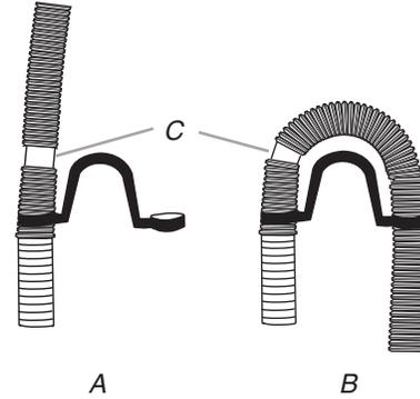
A. Coloque el extremo de la manguera de desagüe alrededor de la manguera, en la hendidura de la manguera de desagüe. Apriete el seguro del molde de la manguera de desagüe hasta que encaje en su lugar.
