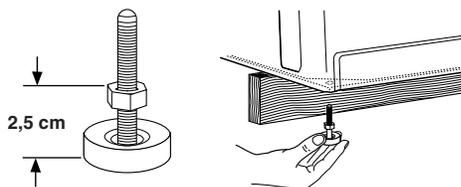
3. Atornille las patas en los orificios adecuados en la esquina delantera de la lavadora hasta que las tuercas toquen la lavadora.
