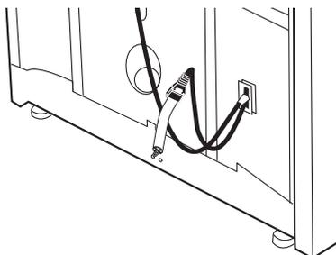
2. Tome con firmeza el cable de suministro de energía y jálelo para quitar por completo el cable de suministro de energía, la sujeción de cable y la claveta del panel posterior.
