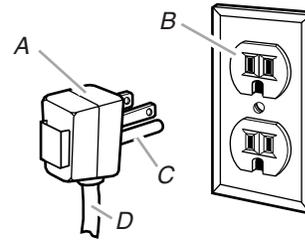
A. Clavija de 3 terminales con conexión a tierra
