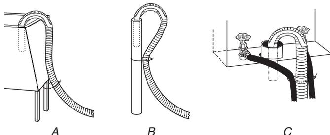
Si los grifos de la lavadora y el tubo vertical de desagüe están empotrados, ponga el extremo en forma de gancho de la manguera de desagüe en el tubo vertical. Enrolle con firmeza el fleje rebordeado alrededor de las mangueras de entrada del agua y la manguera de desagüe. Vea la ilustración C.
