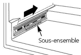
Pour remplacer, poussez le bras de la glissière du tiroir dans la caisse de l'appareil
