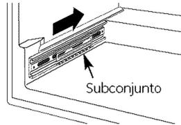
Para sustituirlo, empuje el brazo de deslizamiento del cajón hacia la unidad
