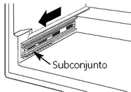
Empuje el pequeño subconjunto de deslizamiento completamente hacia delante
