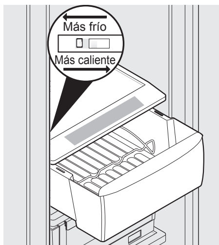
Cajón de enfriamiento con control de temperatura
