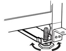
4. Utiliser un niveau pour revérifier que la machine à glaçons est d'aplomb d'avant en arrière et transversalement. Si elle n'est pas d'aplomb, répéter les étapes 2 et 3. Si la machine est d'aplomb, passer à la section "Raccordement à l'alimentation en eau".
