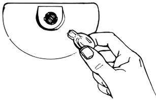
4. Réinstaller le couvercle de la grille de coupe avec les 3 vis.
