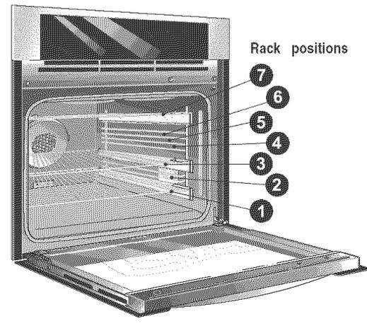
**Arranging Oven Racks** **ALWAYS ARRANGE OVEN RACKS WHEN THE OVEN IS COOL (PRIOR TO OPERATING THE OVEN).**
