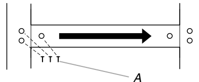
A. Tornillos con el mismo acabado que el exterior
