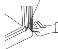
**7.** Faire coulisser l'extrémité supérieure de chaque tringle de garniture vers le haut dans les rails latéraux du four. Pousser chaque tringle de garniture pour qu'elle s'emboîte à l'extrémité inférieure. Utiliser les vis pour fixer chaque tringle de garniture sur le four. Veiller à ne pas érafler d'autres surfaces avec les extrémités de la garniture.
