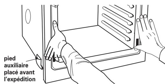
Pousser contre la zone du joint du châssis avant pour insérer le four dans l'espace d'encastrement, jusqu'à ce que le pied auxiliaire installé avant l'expédition soit presque en contact avec le placard. Avec un tournevis Phillips, ôter les vis fixant le pied auxiliaire. Ôter et jeter le pied auxiliaire. Pousser complètement le four dans l'espace d'encastrement dans le placard; centrer le four dans l'ouverture découpée dans le placard.
