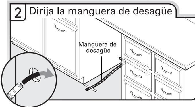
Dirija la manguera de desagüe como se muestra a través del orificio en el armario, hacia la parte central frontal de la abertura, en donde se hará la conexión del desagüe. Pegue la manguera de desagüe al piso con cinta adhesiva en el área mostrada. Esto evitará que la misma se mueva al colocar la lavavajillas dentro de la abertura del armario.
