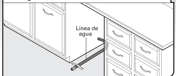
Dirija la línea de agua y péguela al piso con cinta adhesiva en el área mostrada. Esto evitará que la misma se mueva al colocar la lavavajillas dentro de la abertura del armario.
