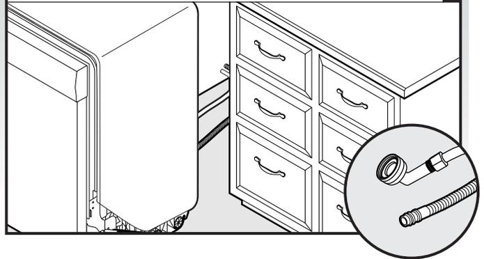
Verifique que la línea de agua esté en el lado izquierdo de la abertura y que la manguera de desagüe esté cerca del centro de la abertura del armario.
