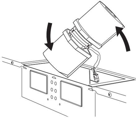
6. Rote el motor del soplador de manera que las lumbresas de escape queden mirando la parte posterior del horno de microondas y bájelo nuevamente dentro del horno de microondas.
