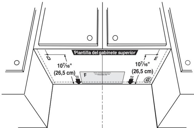
5. Corte un orificio de  $1\frac{1}{2}$ " (3,8 cm) de diámetro en el área sombreada circular "G" en la plantilla. Este orificio será para el cable de suministro de energía.
