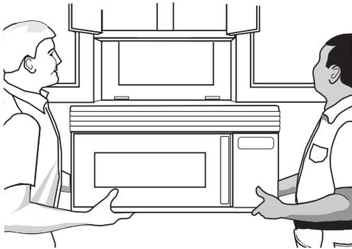
3. Con la ayuda de 2 o más personas, levante el horno de microondas y cuélguelo de las lengüetas de soporte en la parte inferior de la placa de montaje.
