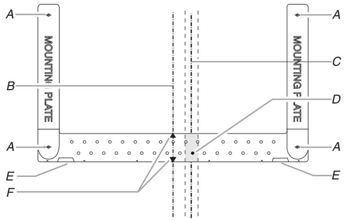
**NOTA:** Si el pie derecho de pared está a no más de 6" (15,2 cm) de la línea central vertical (vea la sección “Marque la pared posterior”), solamente se podrá hacer una instalación con recirculación o una instalación con ventilación en el techo.
