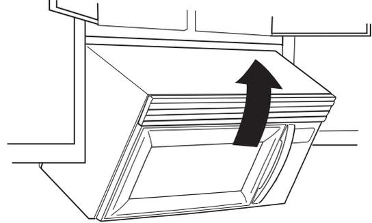
5. Rote el horno de microondas para arriba hacia el gabinete superior.
