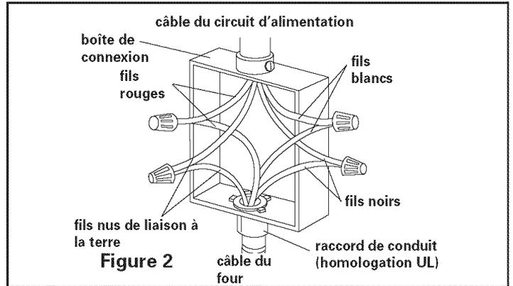
**Si le code local NE PERMET PAS le raccordement du conducteur de liaison à la terre de la caisse au fil neutre (blanc) dans la boîte de connexion :**
