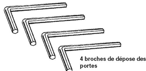
4 broches de dépose des portes
