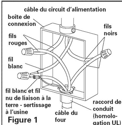
**Si le code local le permet, connecter le fil de liaison à la terre de la caisse au fil neutre blanc de la boîte de connexion :**
