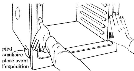
Pousser contre la zone du joint du châssis avant pour insérer le four dans l'espace d'encastrement, jusqu'à ce que le pied auxiliaire installé avant l'expédition soit presque en contact avec le placard. Avec un tournevis Phillips, ôter les vis fixant le pied auxiliaire. Ôter et jeter le pied auxiliaire.
