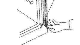
**7.** Faire coulisser l'extrémité supérieure de chaque tringle de garniture vers le haut dans les rails latéraux du four. Pousser chaque tringle de garniture pour qu'elle s'emboîte à l'extrémité inférieure. Utiliser les vis pour fixer chaque tringle de garniture sur le four. Veiller à ne pas érafler d'autres surfaces avec les extrémités de la garniture.
