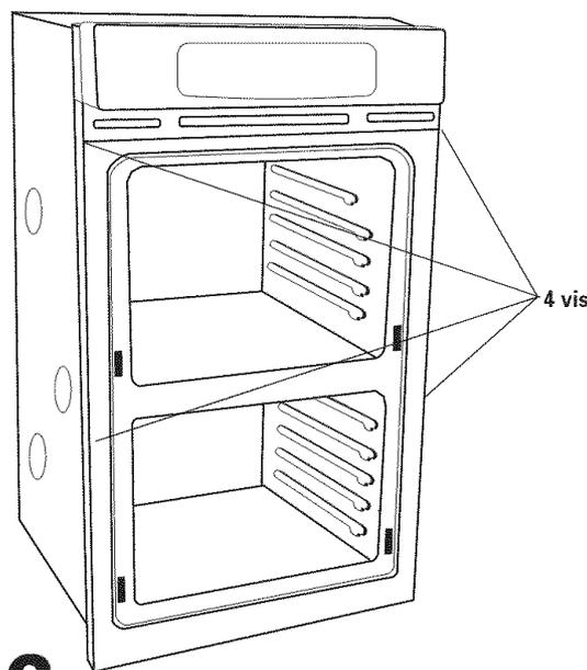
**6.** Important : Fixer solidement le four au placard avec les vis fournies (deux vis pour un four indépendant ou quatre vis pour les fours superposés). Insérer les vis dans les trous des tringles de montage. Ne pas serrer excessivement les vis.
