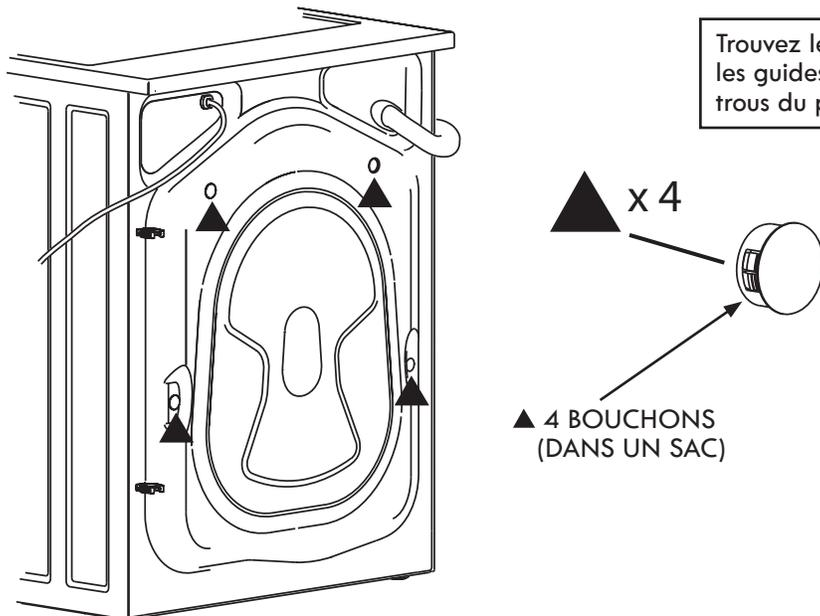
Trouvez les 7 bouchons du petit sac fourni avec les guides de votre laveuse. Insérez-les dans les trous du panneau arrière de la laveuse.
