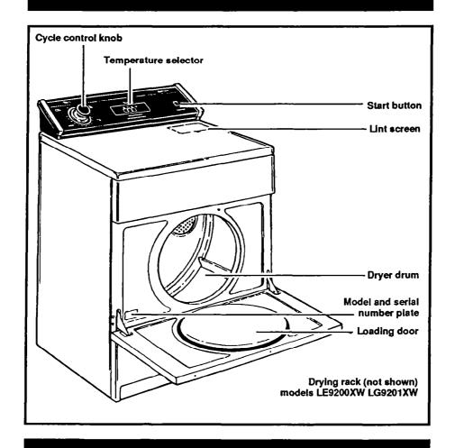
LARGE CAPACITY AUTOMATIC DRYERS LE9100XT LG9101XT LE9200XW LG9201XW
