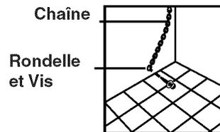
2. À l'aide de la longue vis fournie, ancrez la chaîne au plancher ou au mur.
