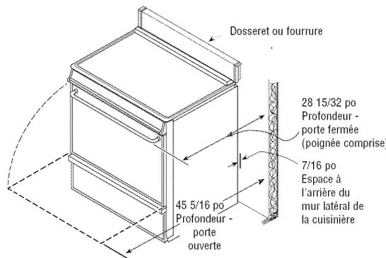
▲ Les côtés, dos et fond des armoires doivent être solides. Le fond doit être solide au niveau du plancher ou avec le bord inférieur de la découpe. Toute ouverture autour des sorties de gaz ou électriques doit être scellée. Toutes les ouvertures d'armoires doivent être scellées au moment de l'installation pour empêcher les courants d'air. Les courants d'air affectent l'utilisation sécuritaire du four.
