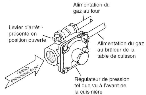
6. Installez un raccord évasé de 1/2 po au coude à filetage interne NPT de 1/2 po du régulateur de pression.
