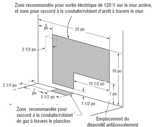
1. Installez un robinet d'arrêt manuel dans la conduite principale de gaz dans un emplacement facilement accessible.
