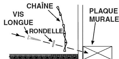
3. À l'aide de la longue vis fournie, ancrez la chaîne au plancher ou au mur.
