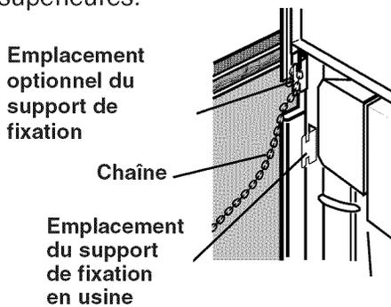
Les ouvertures supérieures sont destinées à être utilisées avec un ensemble de dossier en option. Si un ensemble de dossier est utilisé, on peut déplacer le support de fixation et l'installer en même temps que l'ensemble de dossier en option. Si on n'utilise pas de dossier, assurez-vous qu'aucun support structurel du dessus de comptoir n'interfère avec le support de fixation lorsqu'il est situé dans les ouvertures supérieures.
