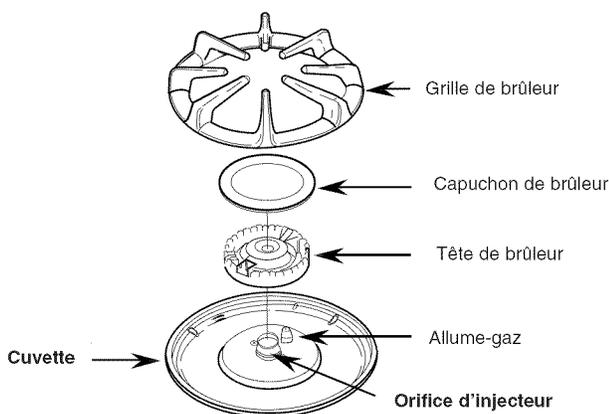
1. Placez la tête de brûleur sur la cuvette. Alignez l'encoche de la tête de brûleur avec l'allume-gaz.
