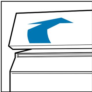
2. Levante el brazo de control eléctrico hasta que enganche en la posición OFF. Aún se puede sacar hielo, pero no se puede hacer más.
