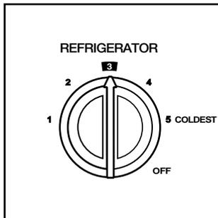
El ajuste del control del refrigerador oscila del 1 (frío mínimo) al 5 (frío máximo).
