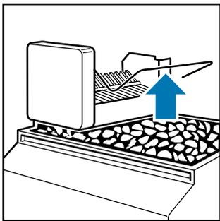
3. Levante y tire de la parte delantera del depósito de hielo para sacarla.
