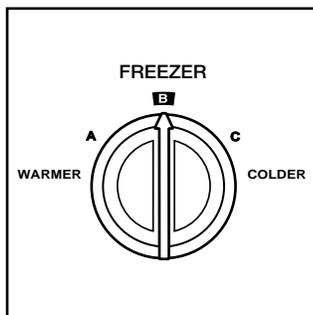
El ajuste del control del congelador oscila de A (frío mínimo) a C (frío máximo).
