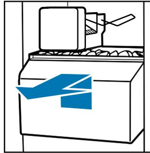
4. Vacíe el depósito de hielo, si es necesario, utilice agua tibia para derretir el hielo. **No use instrumentos afilados** para romper el hielo en el depósito, pues podría dañar el mecanismo de distribución.
