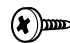
Parte frontal del tornillo de sello para la manija de la puerta
