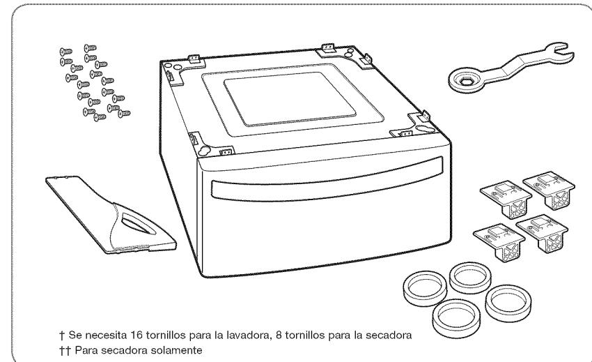
† Se necesita 16 tornillos para la lavadora, 8 tornillos para la secadora
