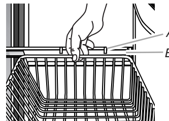
A. Agrafe du support B. Support de panier
