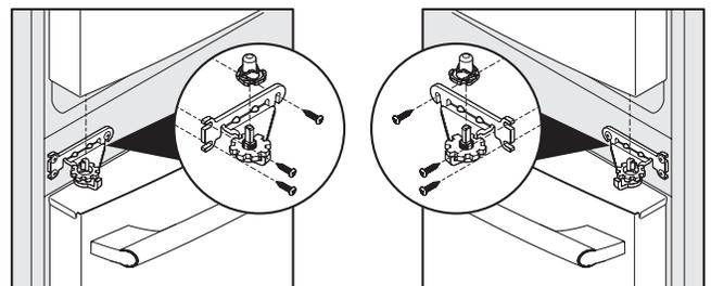
Una vez que ambas puertas estén en su lugar, asegúrese de que estén alineadas la una con la otra y que estén niveladas (vea la sección "Instalación" para obtener más detalles) y vuelva a colocar la tapa de la bisagra superior.
